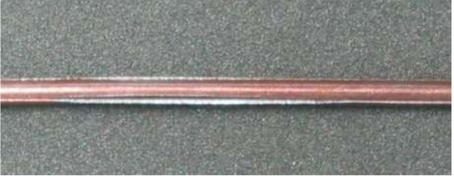
如果焊丝变形横断面形状如下图，可以判定为加压轮过紧所致，因为加压轮槽内侧夹角为 $30^\circ$
